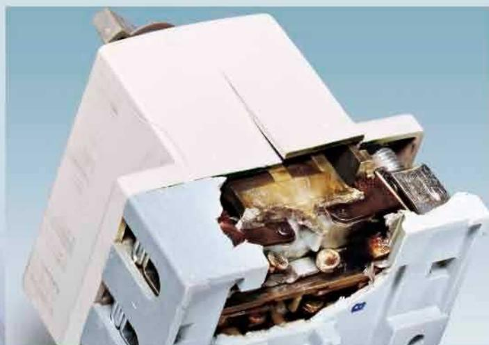
Fig. 1b: Interruptor automático FI destruido (RCD)
